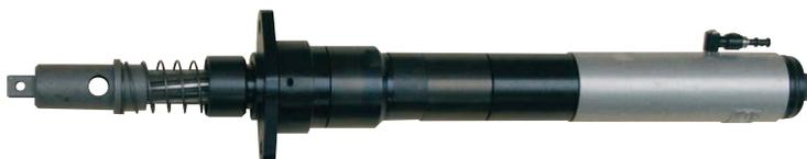
Attacco assiale quadro per bussole a spina, scorrevole con compensatore corsa.
